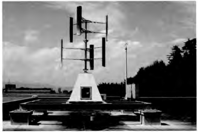
写真：学内に設置した垂直軸風車と発電
