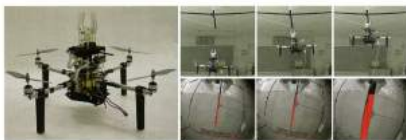
写真2 (左) ロボットハンドを搭載した飛行ロボット。(右上) 飛行しながら棒を把持する様子。(右下) 棒に対するハンドの位置決めはリアルタイム視覚フィードバック制御により実現している。(ICROS2015にて発表)
