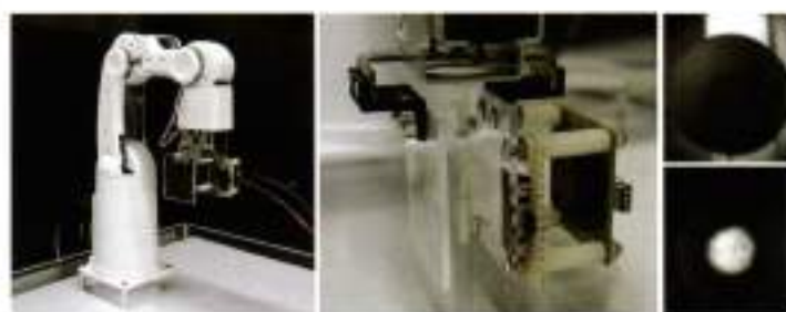
写真3 (左) 複合センサを搭載したロボットアーム。(中) 接触・近接複合センサ。(右上) センサから得られた把持物体の可視光画像。(右下) 接触領域の検出結果。(ICRA2016にて発表予定)
