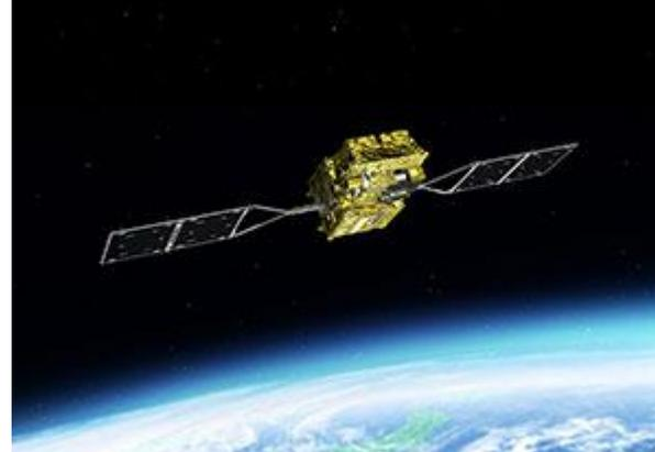
GCOM-Cは、気候変動に影響を及ぼす、地球上の様々なデータを取得して、温暖化などの気候変動メカニズムの解明や黄砂の飛来状況監視、海洋プランクトンの観測による漁場推定などに使用する人工衛星。観測対象である雲・大気中のちり(エアロゾル)・植生(森林)・雪氷・海を観測する。
