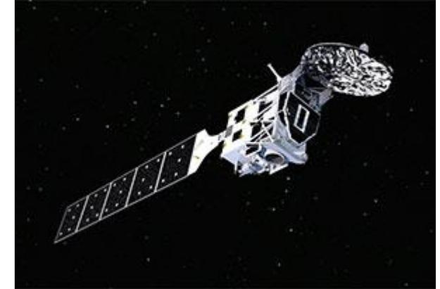
日本と欧州が協力して開発を進める地球観測衛星。搭載する4つのセンサ(雲プロファイリングレーダ、大気ライダー、多波長イメージャーおよび広帯域放射収支計)により、雲、エアロゾル(大気中に存在するほこりやちりなどの微粒子)の全地球的な観測をする。
